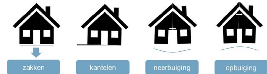
Figuur 14: Beweging van gebouwen bij vervormingen van bodem en fundering
