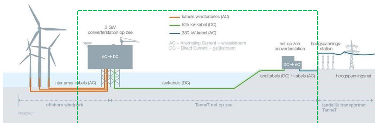
Figuur 2-1 Onderdelen elektrische verbinding van een 2GW-gelijkstroomverbinding
