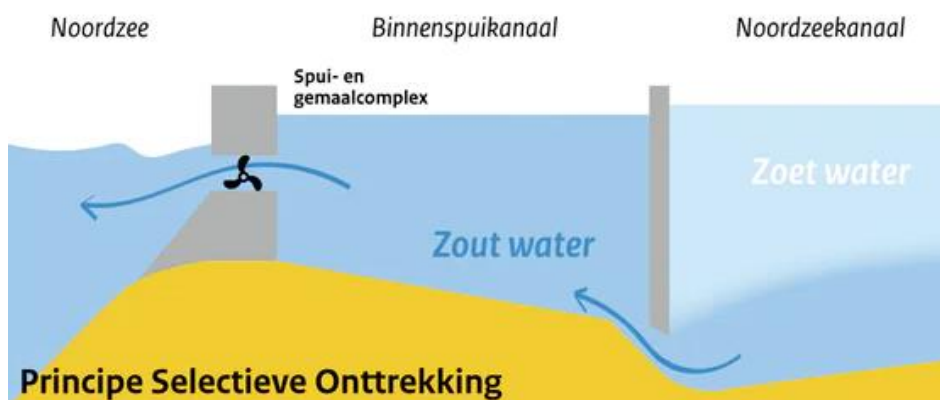
Figuur 3 Principeschets werking selectieve onttrekking
