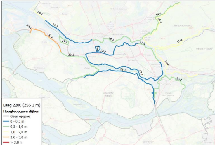
Figuur 53: Waterveiligheidsopgave voor hoogte bij 1 m zeespiegelstijging (tijdlijn Laag 2200) voor deelgebied Rijnmond-Drechtsteden.
