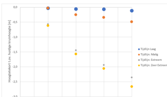
Figuur 175: Hoogtetekort Spuimiddel sluis Empel.
